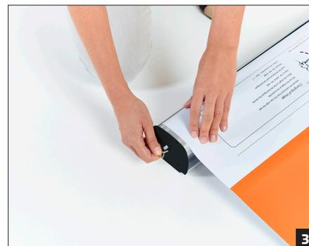
Inserire la chiavetta nel piccolo foro ubicato sul fianco dell'avvolgitore. Far scorrere nuovamente in dentro la stampa fino a che la chiavetta non si innesta completamente nel foro. A questo punto la stampa è fissata.
